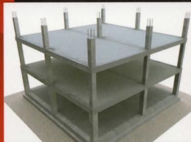
Rapidità di realizzazione, elevata risposta alle sollecitazioni sismiche ed ottima adattabilità sono i punti di forza della tecnologia costruttiva del sistema pilastro-trave in calcestruzzo. "Tutto finito ad uscire": il pilastro pluripiano SD in calcestruzzo permette il montaggio di 2 piani alla volta, adattandosi con facilità allo sviluppo di maglie strutturali complesse, a piante con perimetro irregolare e a cantieri con situazioni logistiche precarie.
