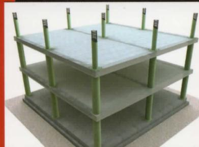
Il cuore di questa soluzione costruttiva è il pilastro tubolare pluripiano in acciaio-calcestruzzo che garantisce la riduzione di circa il 50% della sezione del pilastro, mentre la staffatura interna in acciaio garantisce resistenze al fuoco fino a 180 minuti.
